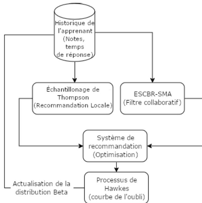
FIGURE 7.12 – Architecture de modèle proposé avec Hawkes
